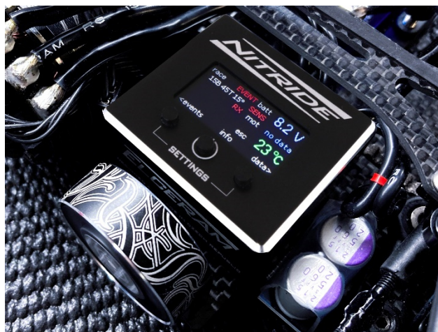
Příklad instalace NITRIDE do on-road vozu s ventilátorem pro použití s motorem 4,5T na asfaltu
